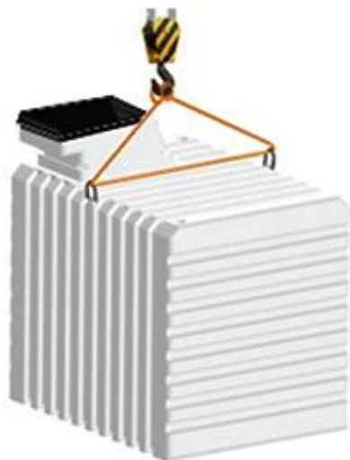
Рисунок 3. Крепление стропой 2СК-1,0
